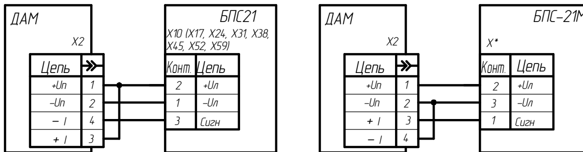
Рисунок 2.1а - Схема электрическая подключений к БПС21 ИБЯЛ.4.11111.034 (к БПС-21М ИБЯЛ.4.11111.042, выходная колодка (X*) определяется согласно руководству по эксплуатации на БПС-21М)
