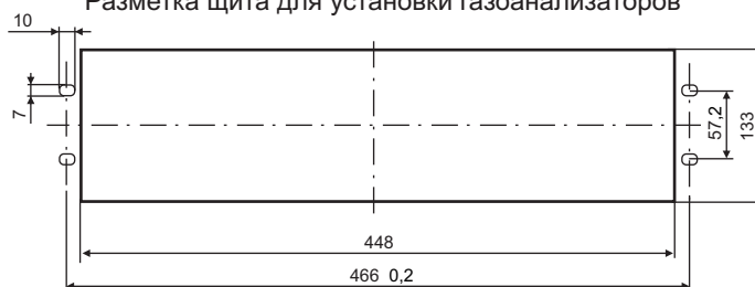
Разметка щита для установки газоанализаторов
