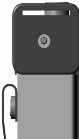
Рис.4. Расположение винта, закрывающего доступ к регулировочным потенциометрам.
